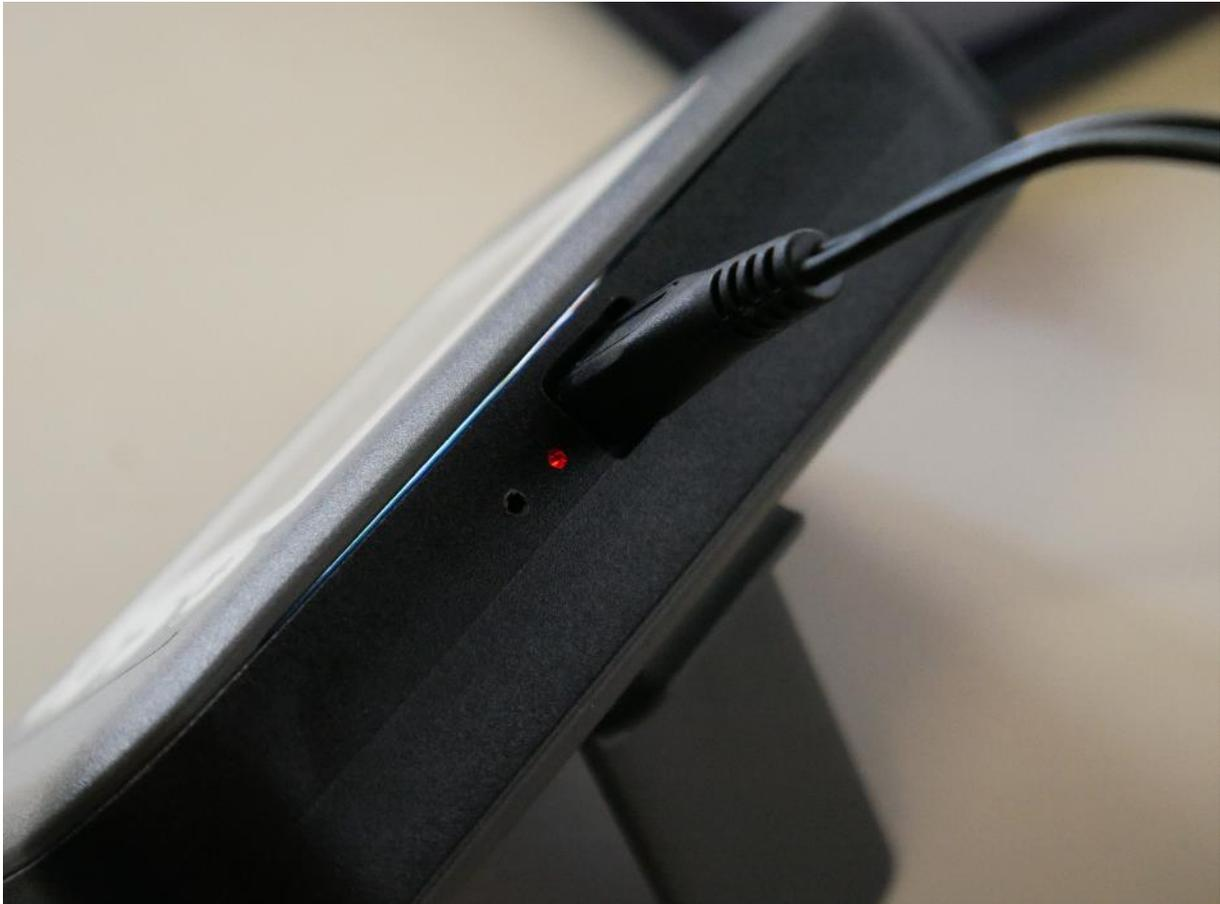
Branchez le chargeur fourni dans la prise USB pour recharger l'afficheur Centor Wireless. La led rouge s'allume pendant la charge et s'éteint une fois la batterie chargée.
