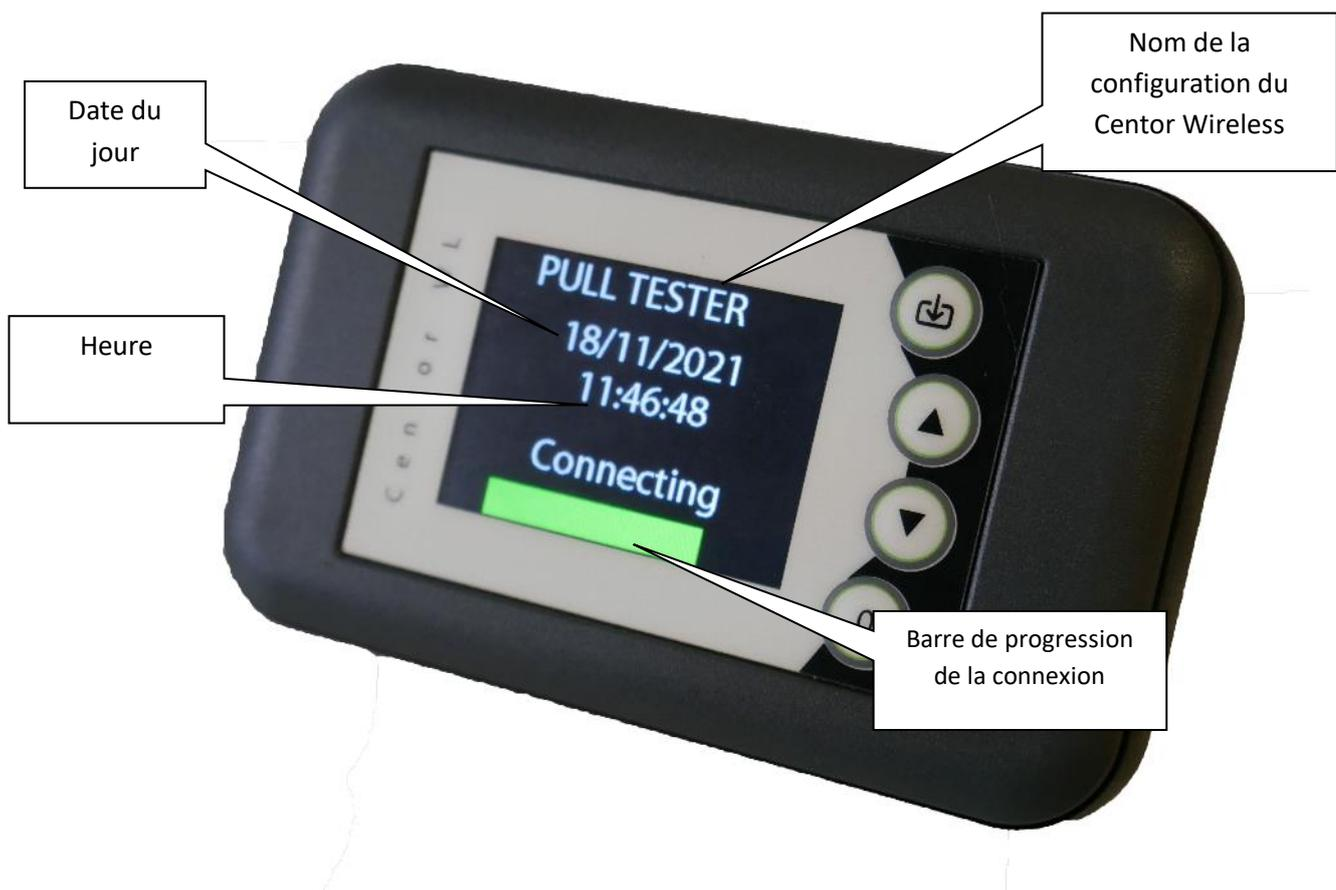
Si vous avez déjà connecté un capteur et qu'il est allumé, le Centor Wireless va s'y connecter automatiquement et vous arriverez alors sur l'écran de mesure. Sinon, le Centor Wireless va chercher les capteurs disponibles.
